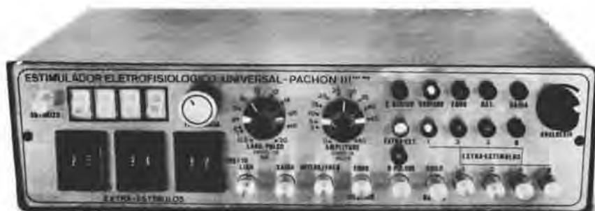
Fig. 2 — Cardíostimulador transesofágico projetado e construído por Pachón & Pachón. Apresenta display digital para controle dos parâmetros da estimulação e um módulo de extra-estímulos que permite a liberação de até três extra-estímulos com intervalos de acoplamento independentes e previamente programados. Pode ser aplicado para estimulação intracavitária ou transesofágica. Nesta última situação permite o acoplamento de um circuito de analgesia que modifica as características do pulso liberado, eliminando o desconforto que eventualmente acompanha este tipo de aplicação.
