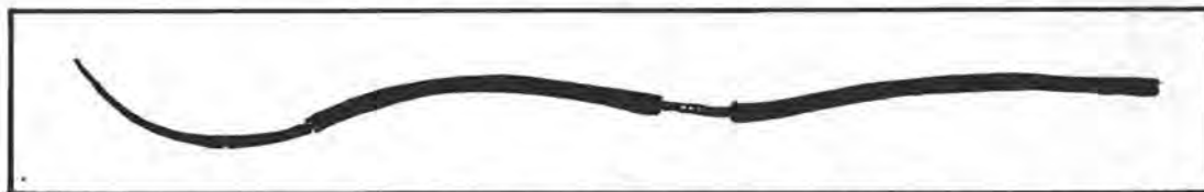
Fig. 3 — Aspecto do cabo-eletrodo com a modificação sugerida, notando-se ausência de fio metálico descoberto à exceção da área utilizada como eletrodo.
