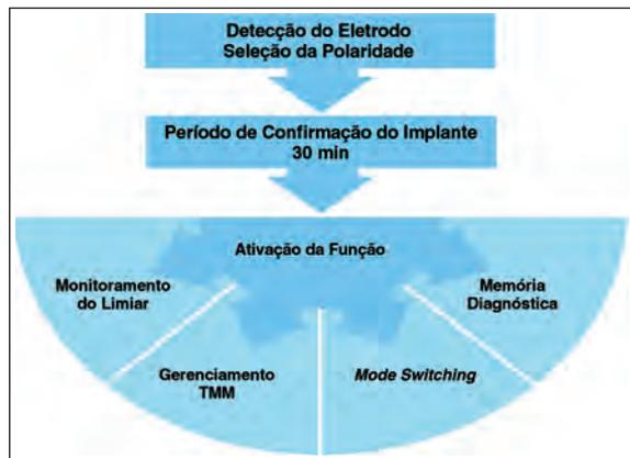
Figura 6 - Processo de detecção dos eletrodos e ativação das funções por meio da Auto-inicialização.
